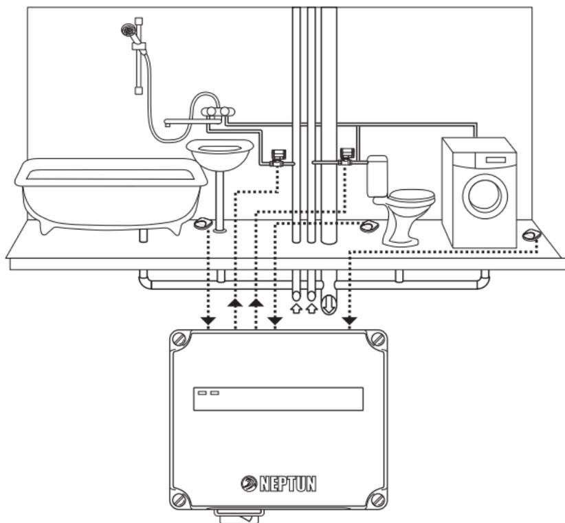
Рис. 1. Пример размещения комплекта в стандартной квартире.
