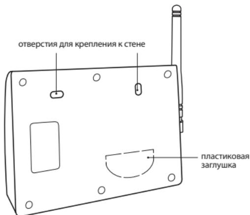
*Рис. 15. Вид модуля управления Neptune ProW+ сзади*
