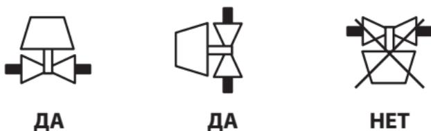
Рис. 3. Рекомендации по ориентации крана в пространстве.
