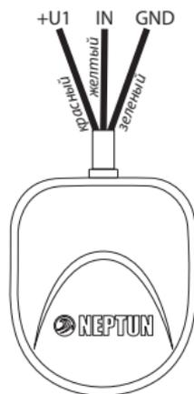
Рис. 6. Маркировка проводов.
