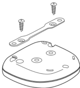
Рис. 2. Установка крепления на радиодатчик
