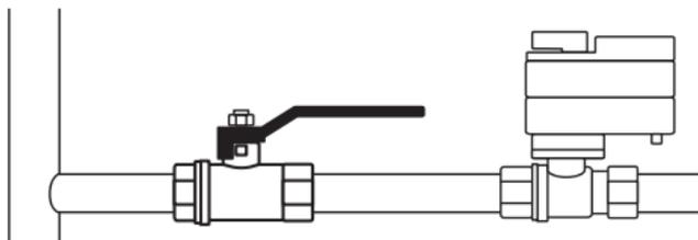
Рис. 2. Схема установки крана шарового с электроприводом.
